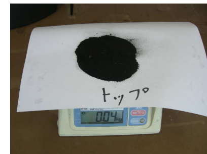
煙突トップを外して、ススの量を計ると40g
