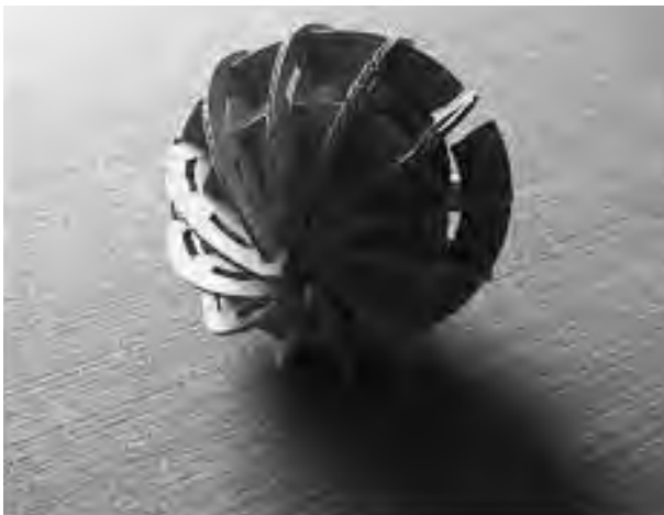
<究極の段ボール緩衝⇒生卵を200mの高さ落下から保護>
