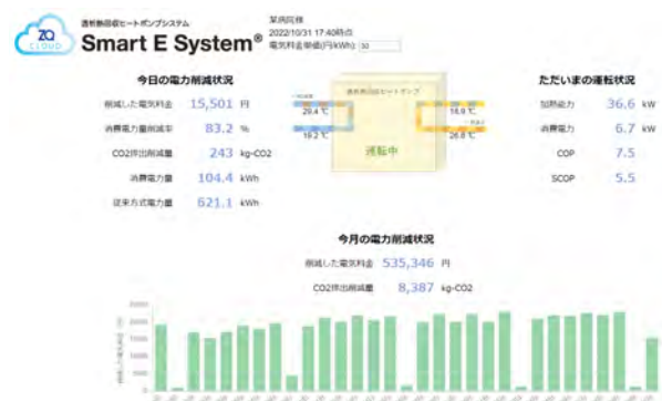
ZQ CLOUD による透析熱回収ヒートポンプのリアルタイム監視画面
